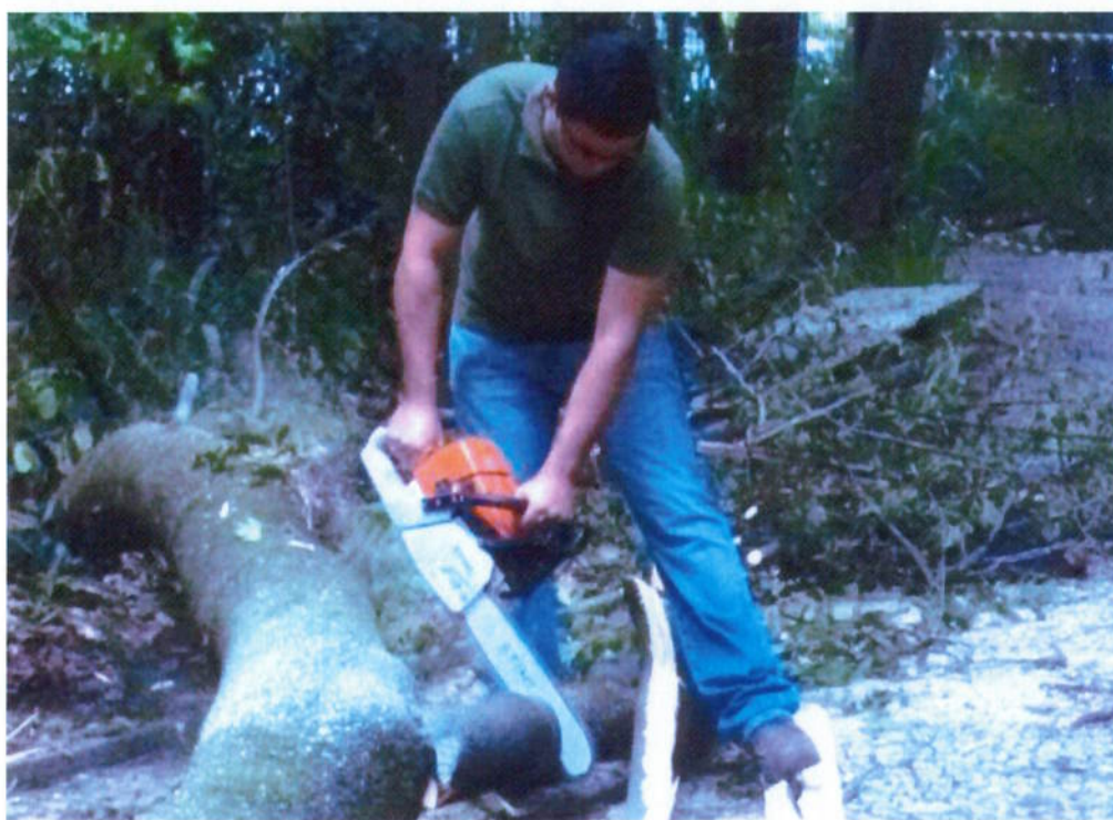
Figura 43: Utilização da motosserra sem os EPI's necessários. Fonte: (Arquivo Pessoal, 2012)
